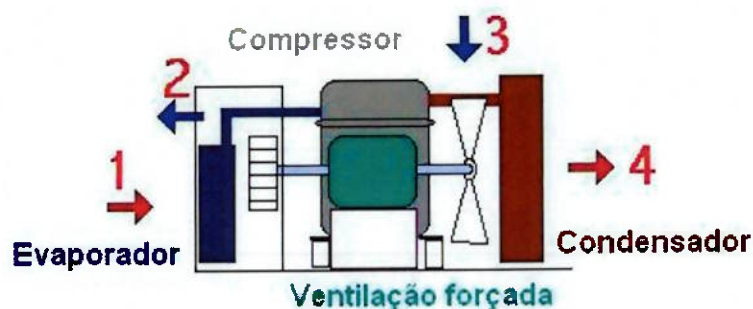
Figura 3 - Funcionamento aparelho de climatização de ambientes
